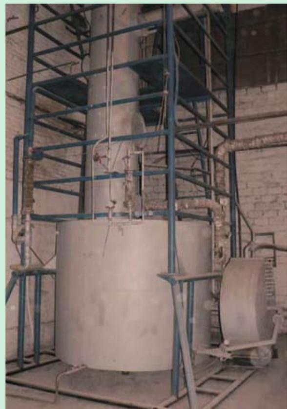
Рисунок 2 – Одноколонный ректификационный аппарат бактерий
