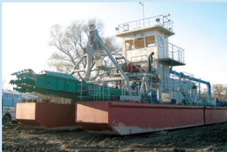
Рисунок 3 – Землесосный снаряд на стапелях перед спуском в канал. Общий вид.
