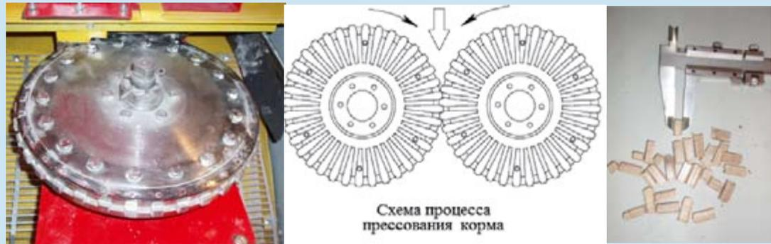
За счет этого энергозатраты процесса гранулирования снизились на 15–45% по сравнению с серийным оборудованием. Кроме того, гранулы при прессовании нагреваются только до 40°С (в серийном грануляторе ОГМ – до 100°С), за счет чего в кормах сохраняются больше питательных веществ и витаминов.
