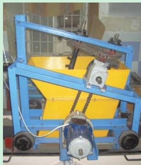
б) привод механизма сводоразрушения
