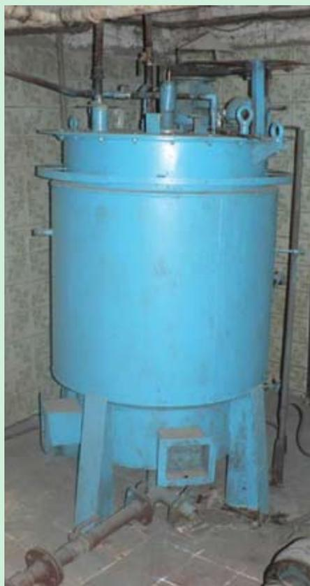
Рисунок 1 – Биореактор для выращивания ацетоно-бутиловых
