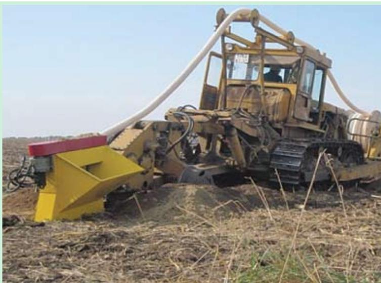
Рисунок 1 – Экскаватор ЭТЦ –208 с экспериментальным бункером
