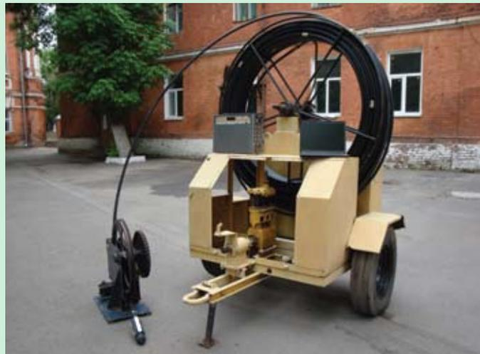
Рисунок 1 – Дренопромывочная машина ДПМ-1
